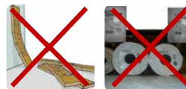
3.3. Caixas e rolos devem ser armazenados em áreas limpas e planas. Respeite o empilhamento máximo das caixas (informação impressa na embalagem) e posicione os rolos na vertical;
