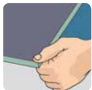
**25.1.** Inicie sempre em uma parede com o encaixe macho da régua voltado para ela;
