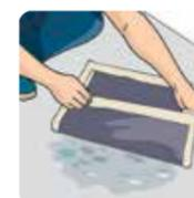
**Método manual** (plástico): Coloque pedaços de plástico (mínimo 40x40cm) em diversos pontos do contrapiso. Prenda toda a borda do plástico com fita adesiva e aguarde 24 horas. Se o plástico “transpirar” ou se o contrapiso ficar mais escuro nessa área significa que a água ainda está evaporando e, portanto, o contrapiso está úmido. Deixe o local ventilado e repita o teste alguns dias depois. Apesar deste não ser um teste preciso ainda é o método mais utilizado.
