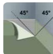
c. Faça um corte de 45° utilizando o molde de ângulo 90°, cole as abas soltas e aplique a solda (em ângulos, não é necessário fresar);
