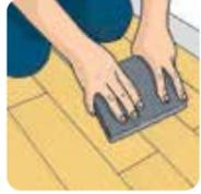
23.6. Ao finalizar, alise as réguas com uma régua de madeira revestida com carpete ou rolo compressor de 50kg, para que fiquem bem aderidas ao contrapiso.
