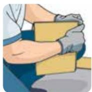
**25.3.** Instale as réguas da primeira fileira, fazendo um ângulo de 20 a 30 graus ao encaixar a parte do topo. Ao final, meça o espaço faltante e corte uma régua na medida exata para preencher esta área;
