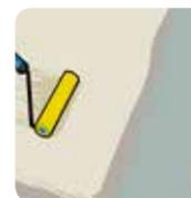
29.2. Se o produto requerer, aplique o adesivo de tack permanente com rolo de espuma, aguarde o tack e inicie a colocação das placas / régua, invertendo o sentido do desenho, se necessário;
