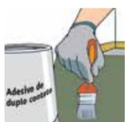
d. O adesivo de duplo contato sem toluol deve ser passado no verso da manta antes da sua aplicação, exatamente na área das bordas que serão usadas para a formação do rodapé;
