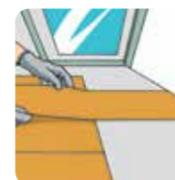
**23.4.** Distribua réguas soltas sobre as últimas coladas (próximas às paredes), encoste-as na parede e com um estilete copie os recortes. Dobre a régua para trás, corte a sobra com o estilete golfinho e encaixe no espaço correto. Repita este procedimento ao longo de todas as paredes;
