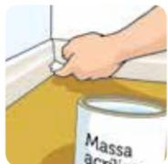
e. Faça os acabamentos das emendas com massa acrílica. Remova o excesso com um pano úmido e limpo;
