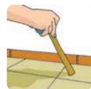
6.2. Cerâmico: com juntas inferiores a 5mm. Se a superfície for vitrificada, antes da aplicação da massa de preparação ou autonivelante, é necessário o uso de um primer abrasivo ou uma demão de adesivo de duplo contato.
