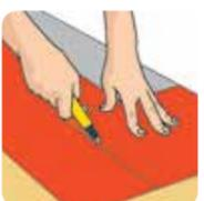
**20.3.** Distribua placas soltas sobre as últimas coladas (próximas às paredes), encoste-as na parede e com um estilete copie os recortes. Dobre a placa para trás e encaixe no espaço correto. Repita este procedimento ao longo de todas as paredes;
