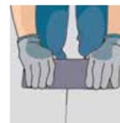
**20.5.** Ao finalizar, alise as placas com uma régua de madeira revestida com carpete, para que fiquem bem aderidas ao contrapiso.
