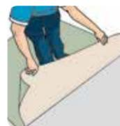
**15.3.** Desdobre a manta para cima do adesivo, trabalhando na direção da parede e respeitando o eixo previamente marcado;
