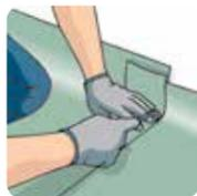
**16.1.2.** A fresa manual com lâmina "U" pode ser utilizada em locais de difícil acesso como paredes, rodapés ou no piso próximo à parede;
