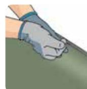
e. Depois de instalar as mantas, espalhe o adesivo de duplo contato na área de colagem da parede e por cima do suporte curvo. Aguarde o tack e molde a manta, encaixando a borda na aba do arremate de rodapé com o auxílio de uma chave de fenda.
