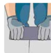
**15.4.** Alise o revestimento com uma régua de madeira revestida com carpete. Posteriormente utilize o rolo compressor de 50kg, a fim de evitar bolhas de ar;
